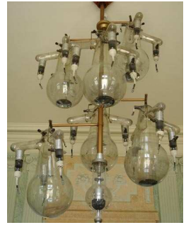
Lampes redresseuses à vapeur de Mercure installées sur l'émetteur de la Tour Eiffel. Exposition internationale de 1937
